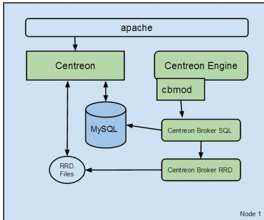
Modulaire et ouvert, la plate-forme de surveillance complète de Centreon comprend trois composants logiciels *open source* majeurs, entièrement optimisés pour fonctionner au mieux ensemble : **Centreon Engine**, **Centreon Broker** et **Centreon Web**. Une API native facilite la configuration automatisée ; par exemple, pour ajouter, supprimer ou mettre à jour des objets hôte et service, ainsi que pour les synchroniser ou redémarrer un *poller* de surveillance à distance.
